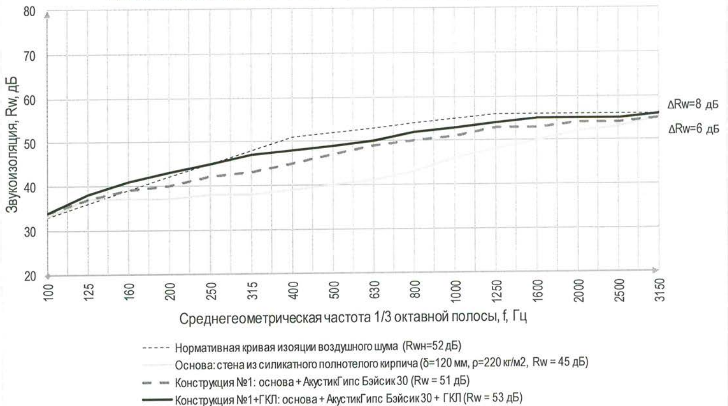
Графики изменения частотных характеристик изоляции воздушного шума, R_w(f) , дБ
